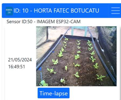
Figura 2: ESP32-CAM tira fotos de 30 em 30 minutos do canteiro experimental de alfaces.
